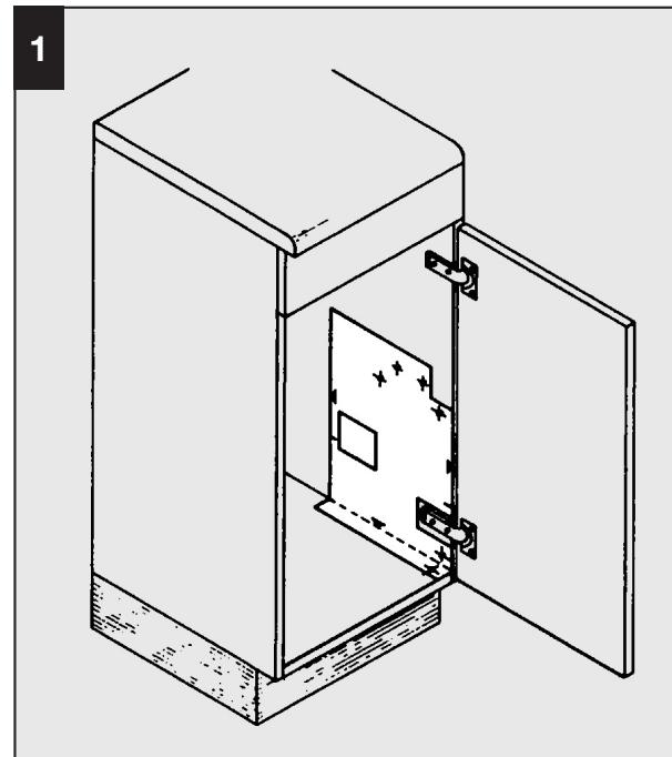
Schablone an Seitenwand und Tür anlegen, Befestigungslöcher ankörnern und Ø 2 mm vorbohren.
