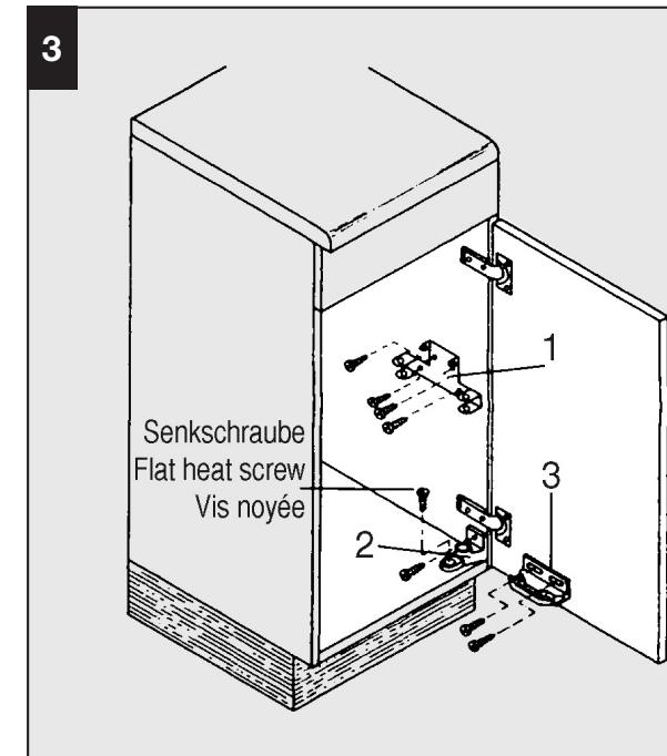
Metter le patron au panneau de côté et à la porte, pointer les trous et forer préalablement Ø 2 mm.
